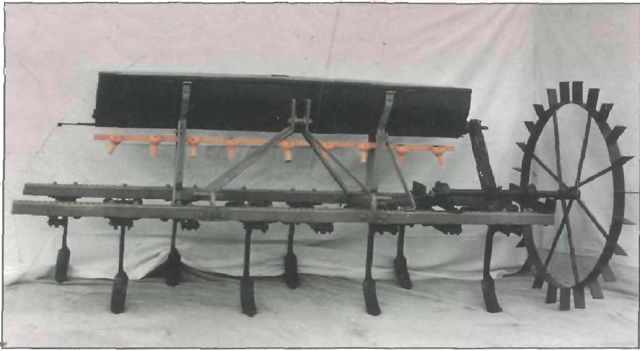
चित्र 6.3 कल्टीवेटर के ऊपर लगी सीडड्रिल में एक तरफ लगा ग्राउण्ड व्हील
