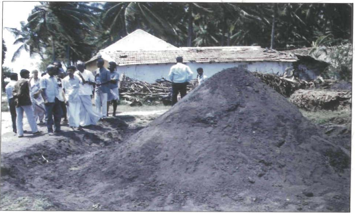
चित्र 21.1. विलायती बबूल की लकड़ियों से कोयले का उत्पादन
