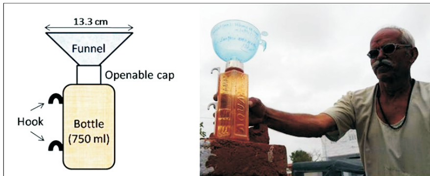
चित्र 10.3 कृषक-मित्र वर्षा-मापक यन्त्र की संरचना Fig. 10.3 Low cost rainfall collector
