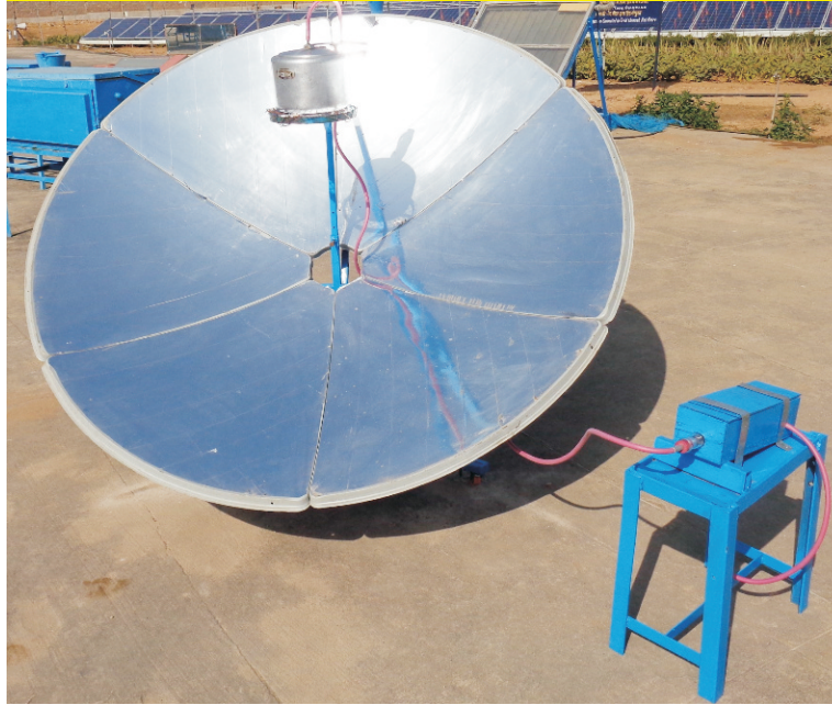
चित्र 8.4 परवलीय संकेन्द्रक सौर तापीय अलवणीकरण इकाई Fig. 8.4 Parabolic concentrating solar thermal desalination device
